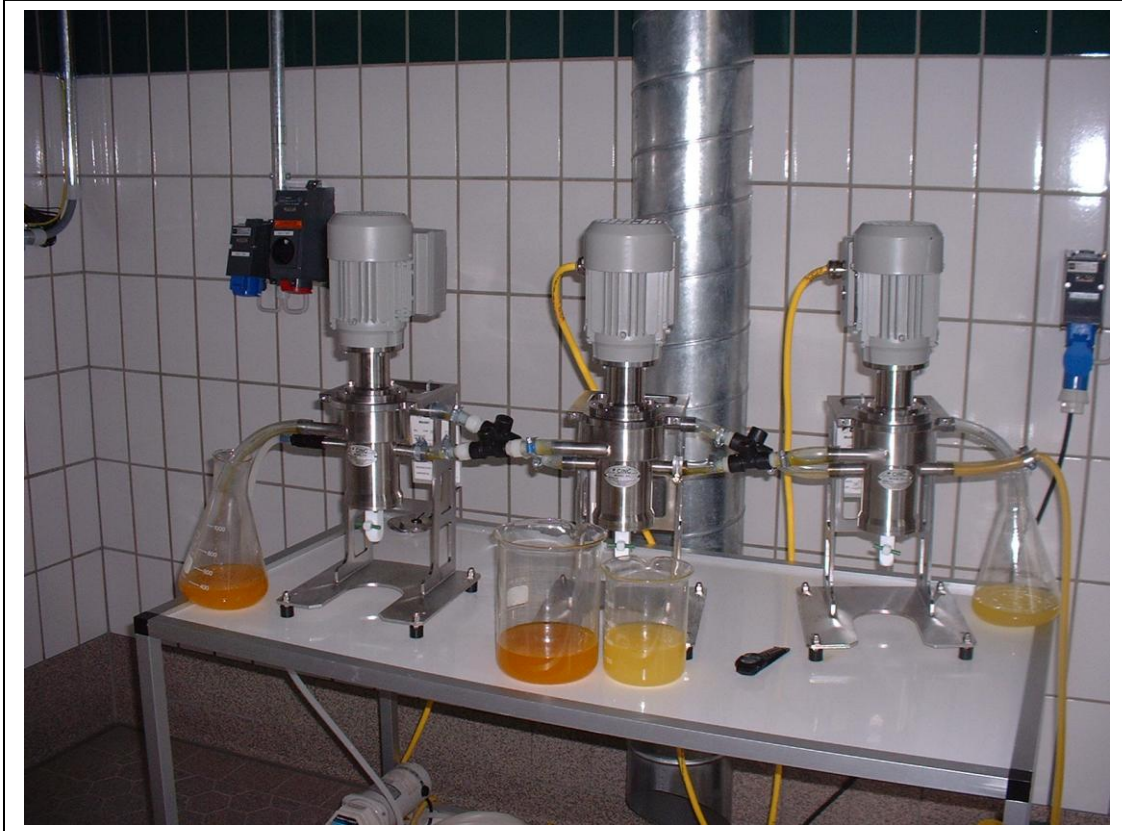
Abb.2 Pilotierung: 3 stufiger Gegenstromwasch- oder Extraktionsprozess Model V02
